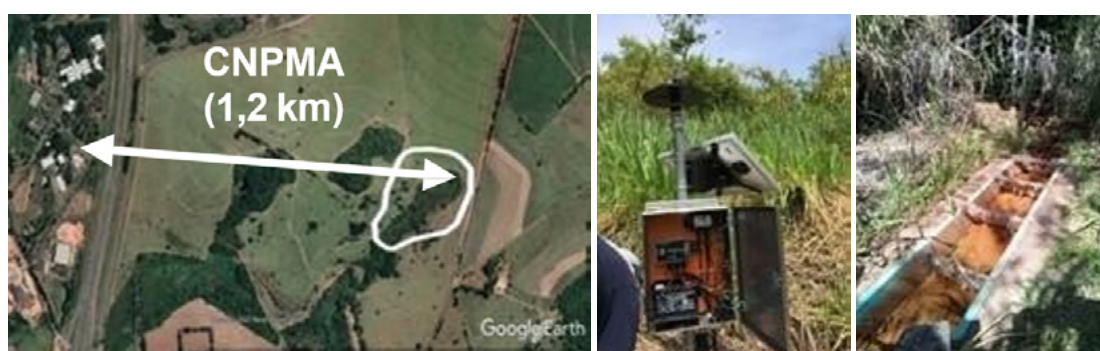
Figura 1. (a) Localização da microbacia monitorada; (b) Sistema instalado na microbacia anteriormente e (c) Calha "H" instalada na área da microbacia.
