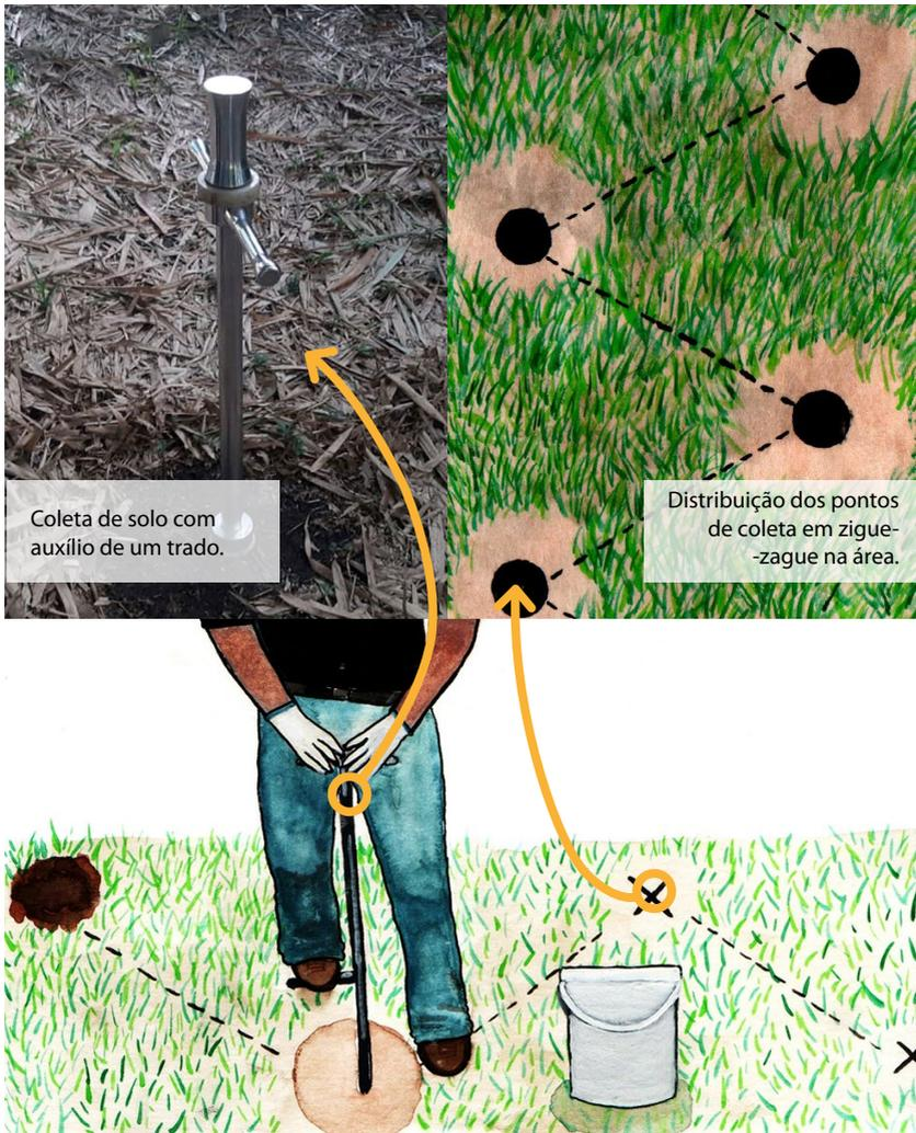
**Figura 2.** Retirada do material para análise.
