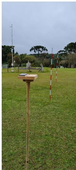
**Figura 3.** Utilização da cruzeta para visualização e enquadramento das balizas e consequente fechamento do perímetro e dos demais vértices da UA, sendo a plataforma nivelada mediante uso de aplicativo para fone celular..
