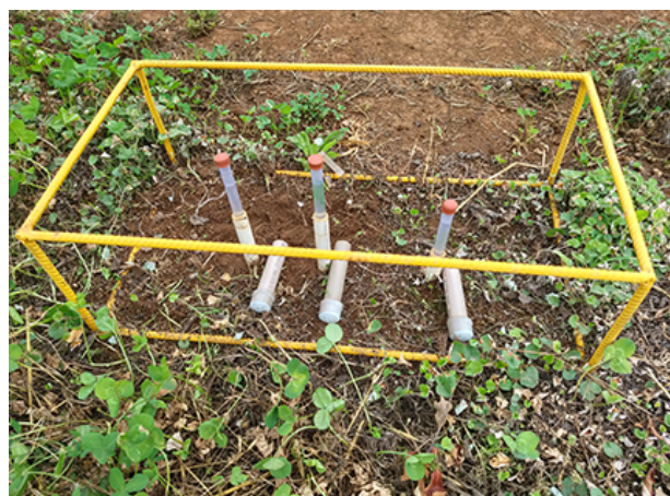
Figura 8. Exemplo de proteção metálica da bateria de tensiômetros e da proteção do tubo de acrílico transparente.
