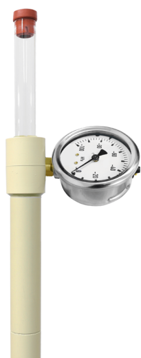
Figura 4. Tensiômetro com vacuômetro metálico tipo Bourdon .
