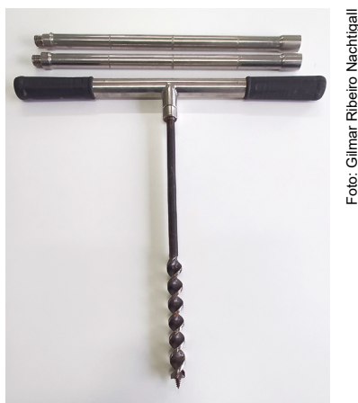
Figura 7. Trado de rosca tipo Mathieson para a instalação de tensiômetros.
