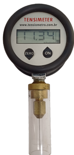
Figura 3. Tensiômetro digital de punção.
