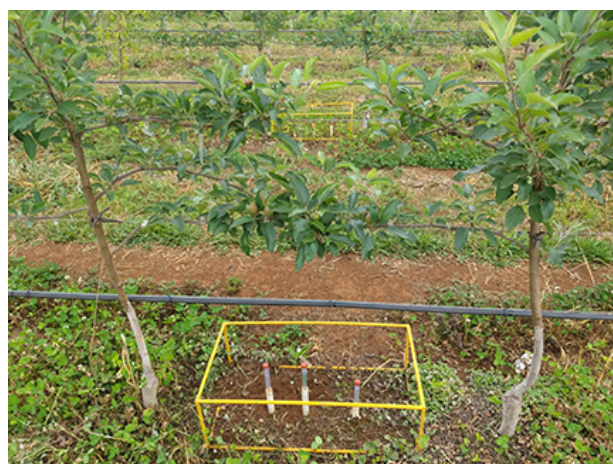
Figura 6. Bateria de tensiômetros instalados nas camadas de 0 a 20 cm, 20 a 40 cm e de 40 a 60 cm de profundidade em pomar de macieira irrigado por gotejamento.
