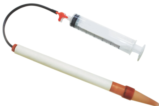
Figura 5. Seringa plástica adaptada para realizar a saturação de tensiômetros.
