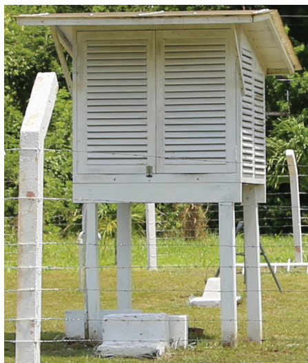
Figura 1. Abrigo meteorológico de madeira da estação agroclimatológica convencional. Embrapa Amazônia Ocidental.
