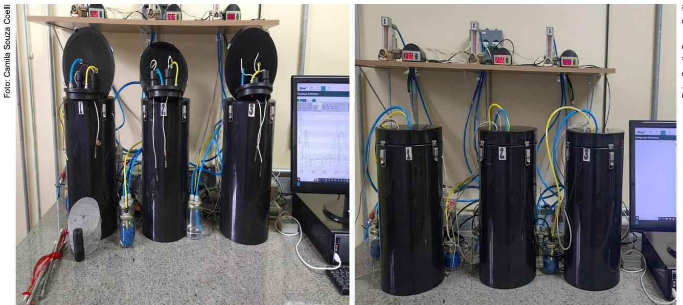
**Figura 1.** Biorreatores de bancada, composteiras escala laboratorial em funcionamento.
