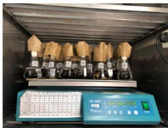
Figura 1. Disposição dos frascos de crescimento em relação à fonte luminosa na incubadora do tipo shaker.
