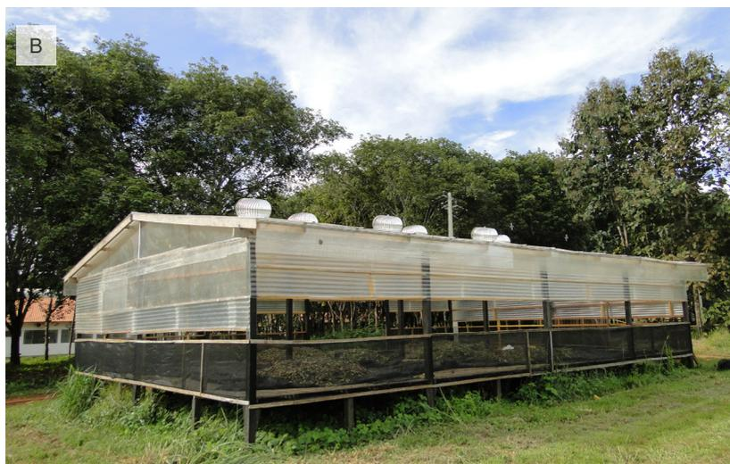
**Figura 20.** Secador solar para biomassa de *Piper aduncum* L.: detalhe da lateral mostrando os aeradores e piso (A); secador finalizado em operação de secagem (B).
