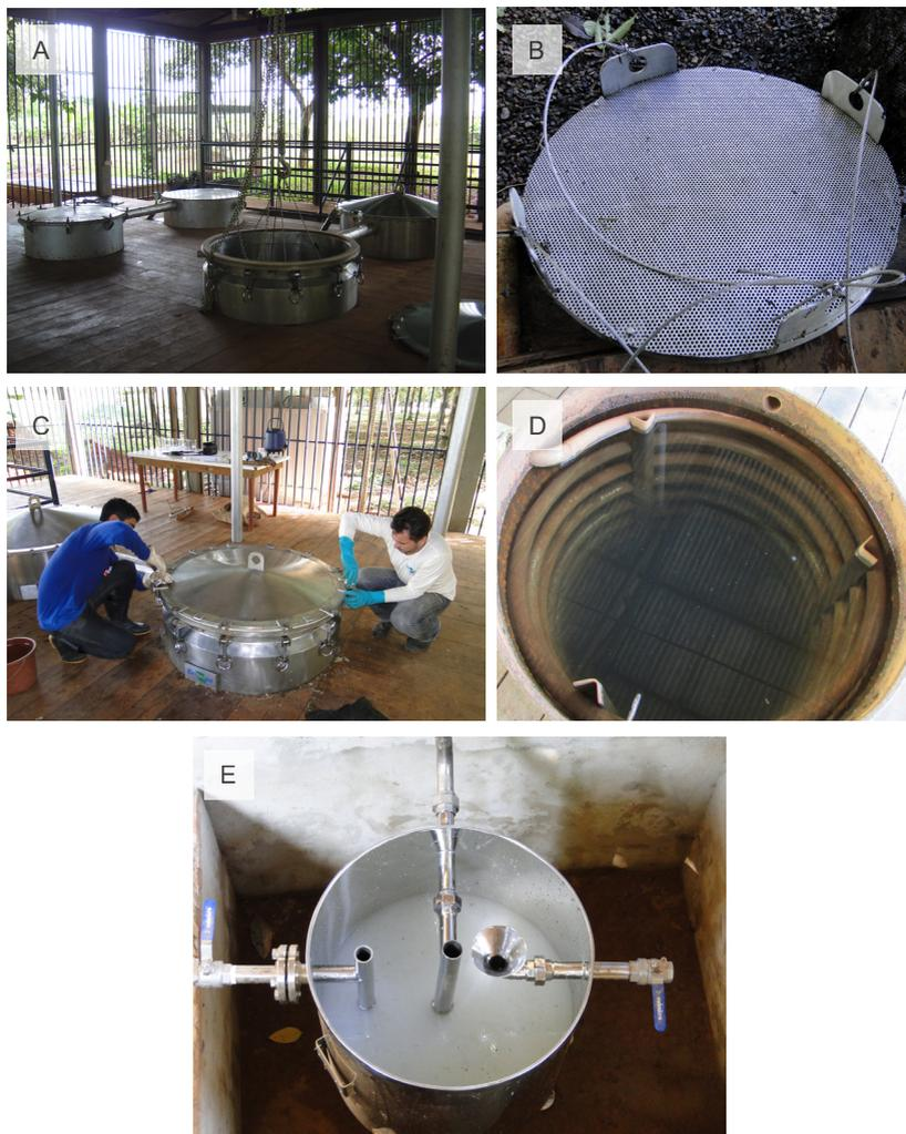
**Figura 21.** Sequência da operação de destilação por arraste de vapor: caldeira acoplada a um extrator (A); detalhe da base telada para passagem de vapor (B); detalhe da tampa acoplada sob pressão (C); serpentina de condensação em um recipiente com água à temperatura de 30 °C (D); coletor para decantação (E).
