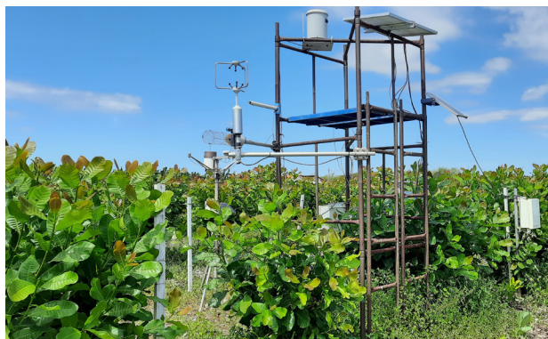
Figura 3. Torre de fluxo com sensores micrometeorológicos utilizada para a determinação da evapotranspiração do cajueiro-anão irrigado. Russas, CE, 2021.
