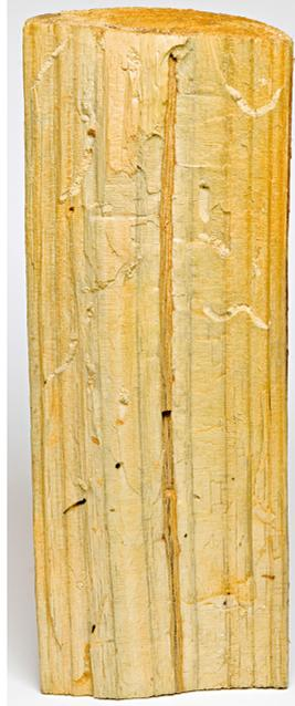
**Figura 11.** Galerias construídas pelas larvas da vespa-da-madeira.
