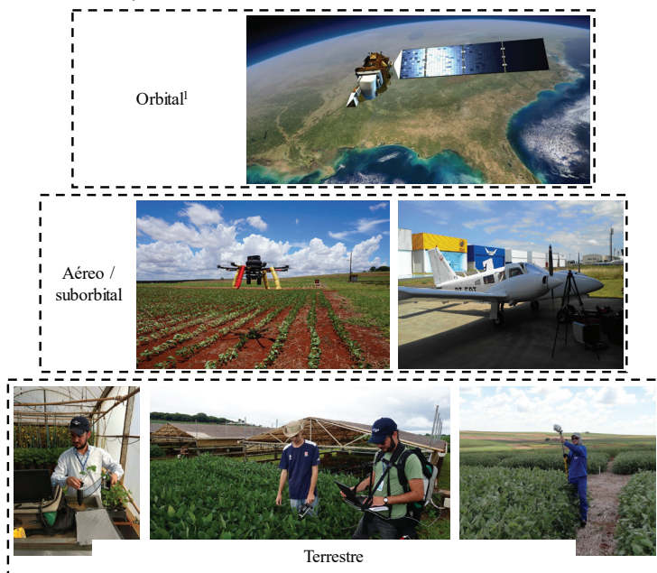
Figura 13. Níveis de aquisição de dados em sensoriamento remoto.
