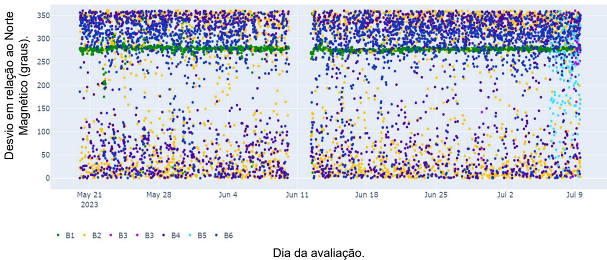
Figura 8. Comparação entre dados de Direção do Vento registrados no interior do Compost Barn, no período de 21 de maio (May) a 9 de julho (Jul) de 2023. Pontos de cores diferentes indicam o registro de direção do vento por diferentes sensores.
