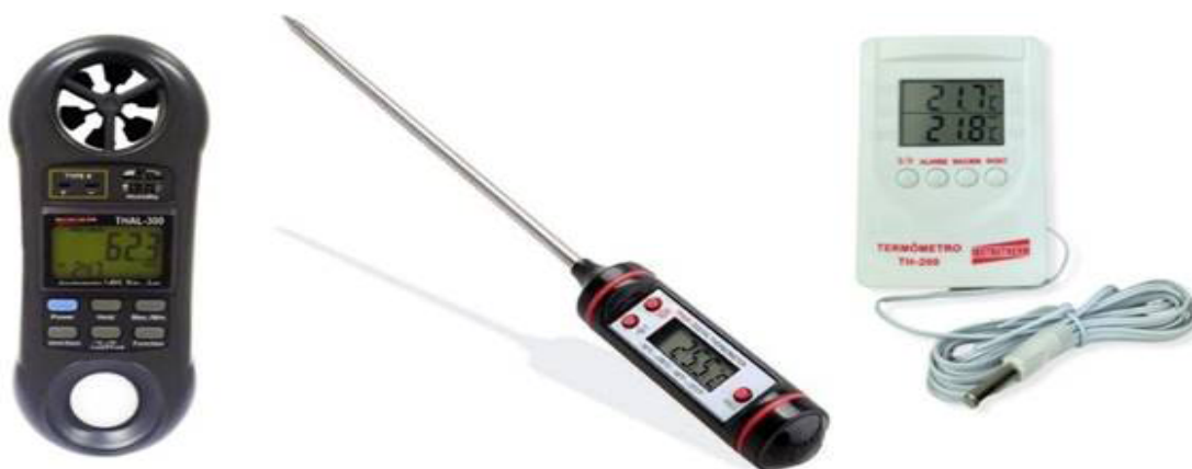
Figura 3. Equipamentos utilizados para medições manuais, da esquerda para a direita: Termo Higo Anemômetro Modelo Thal-300; Termômetro Digital tipo “Espeto” de 23 Cm; Termopar.
