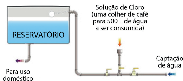
Figura 4. Tratamento de água na produção de leite. Modelo de clorador.
