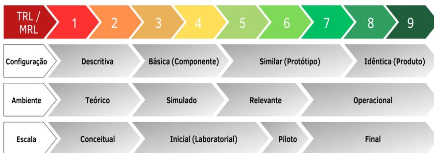
**Figura 3.** Representação esquemática das dimensões Configuração, Ambiente e Escala e suas respectivas etapas no caminhar da escala TRL/MRL.
