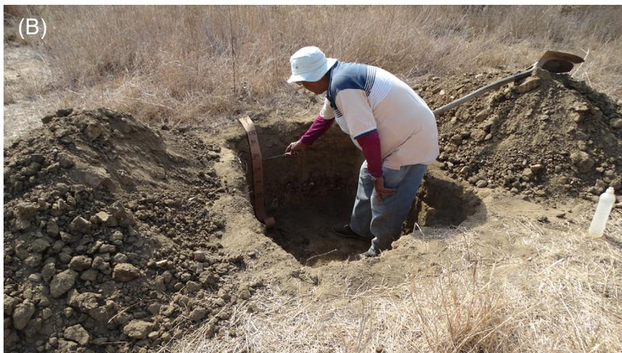
**Figura 4.** Tradagem para exame do solo (A); Exame das características do solo através da descrição de perfis de solo (B).
