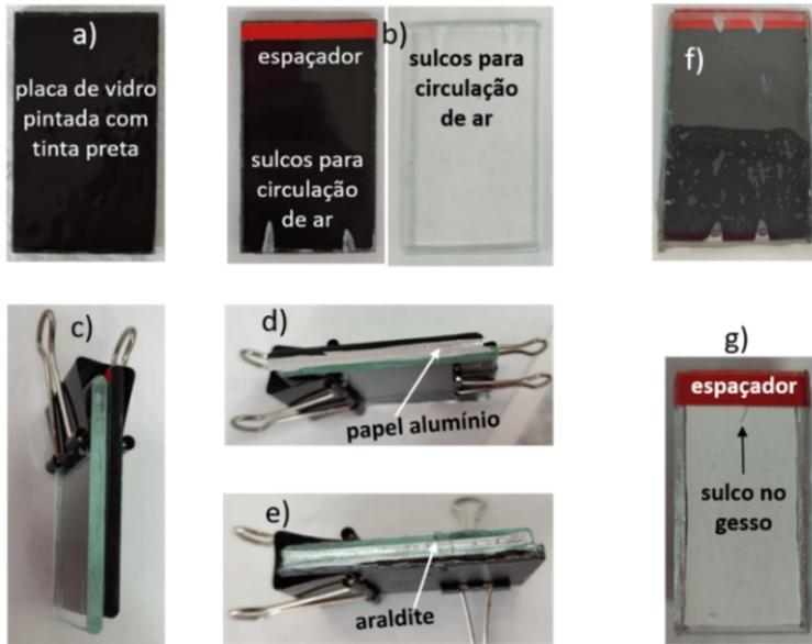
**Figura 2.** Procedimento de construção de sensores de diedro com 2 placas de vidro (a,b,c,d,e) e a configuração final de um sensor de 2 placas de vidro (f), uma de gesso e outra de vidro (g).
