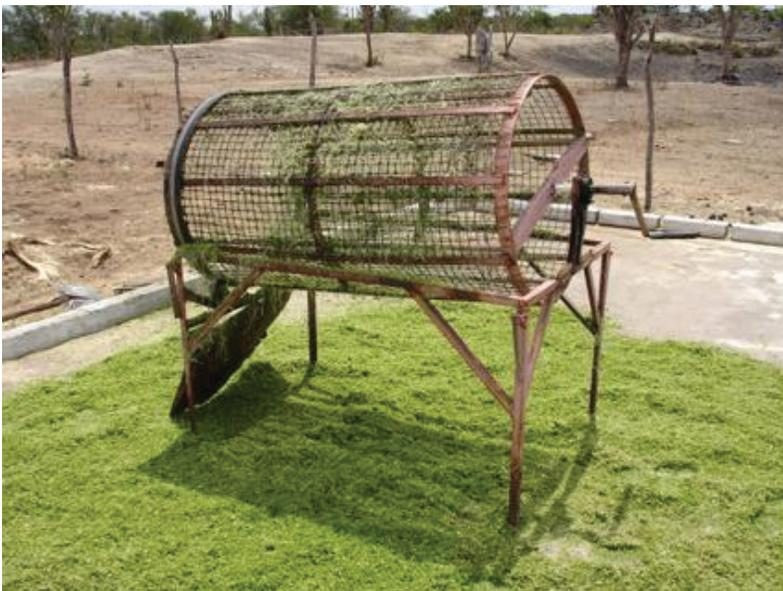
**Figura 7.** Peneira rotativa desenvolvida pela Embrapa para separação da bucha e mucilagem de sisal.
