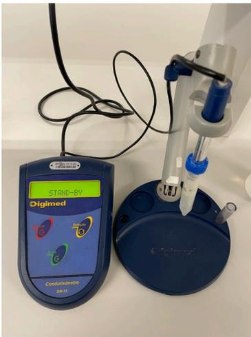
**Figura 4.** Condutímetro de massa para medir a condutividade elétrica da solução de embebição.
