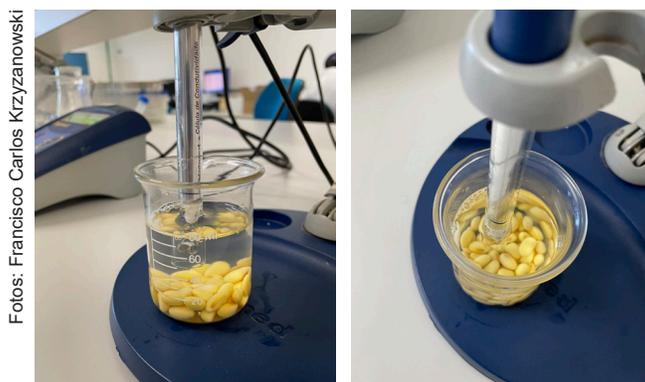
**Figura 14.** Terminal de leitura imerso na solução de embebição cobrindo o eletrodo e sem tocar nas sementes.
