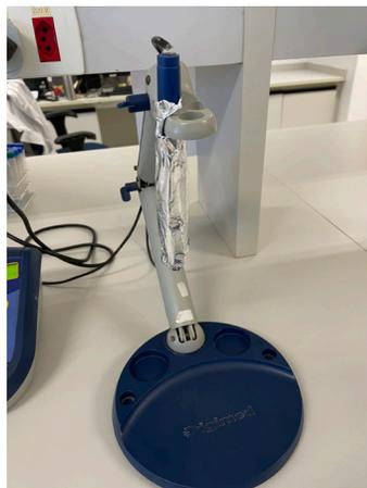
**Figura 10.** Eletrodo do condutímetro de massa protegido no escuro, com lâmina de folha de alumínio.
