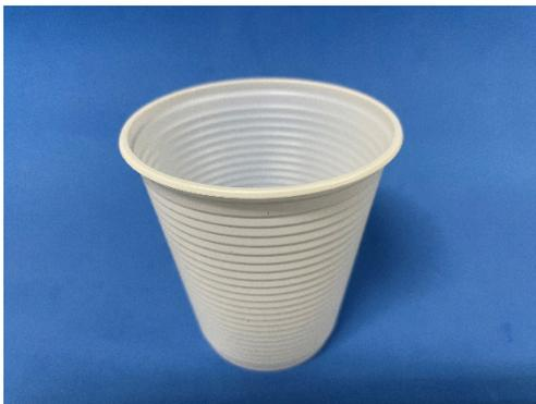
**Figura 6.** Recipiente para embebição das sementes no teste de condutividade elétrica.
