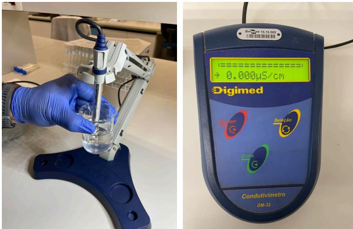
**Figura 12.** Medição da CE da água de embebição.
