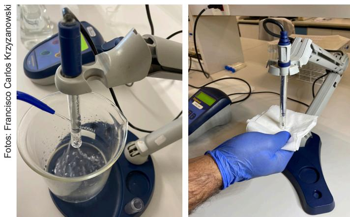
**Figura 13.** Lavagem e secagem do eletrodo.
