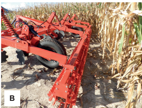
Figura 7. Camalhoeira utilizada tanto para a confecção inicial dos sulco-camalhões quanto para a realização de reparos. Discos de corte (A) e rolo de compactação da superfície do camalhão (B).
