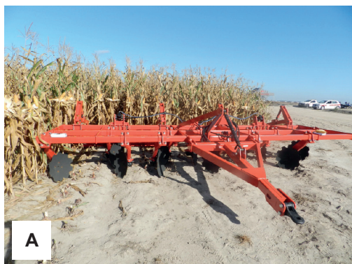
Figura 7. Camalhoeira utilizada tanto para a confecção inicial dos sulco-camalhões quanto para a realização de reparos. Discos de corte (A) e rolo de compactação da superfície do camalhão (B).
