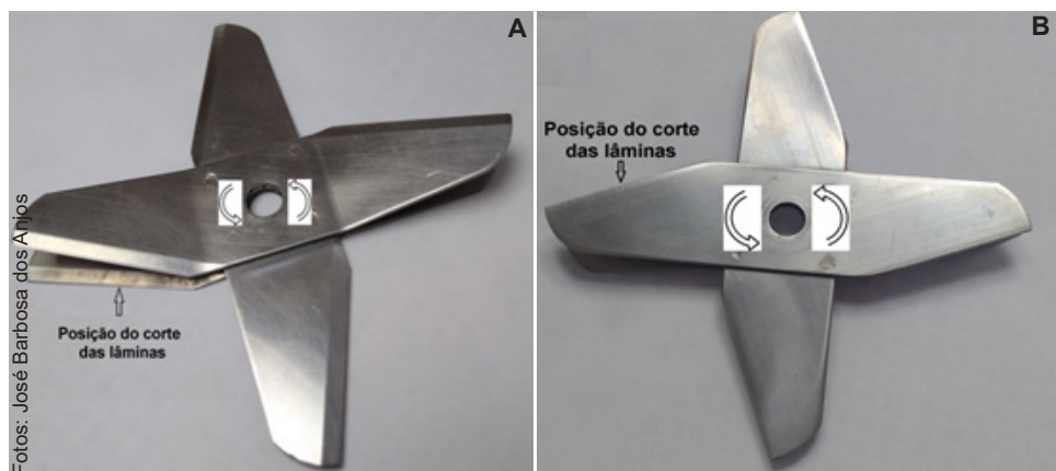
Figura 1. Lâminas na posição indicada pelo fabricante (A) e lâminas (invertidas) na posição sugerida (B).
