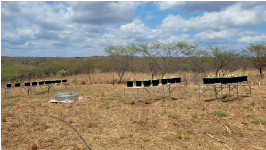
Figura 2. Localização do tanque Classe A, na área das plantas avaliadas em ambiente pleno sol.
