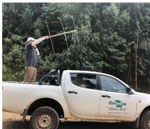
Figura 8. Monitoramento com antena direcional Yagi VHF para localização e rastreamento dos javalis equipados com colares GPS.
