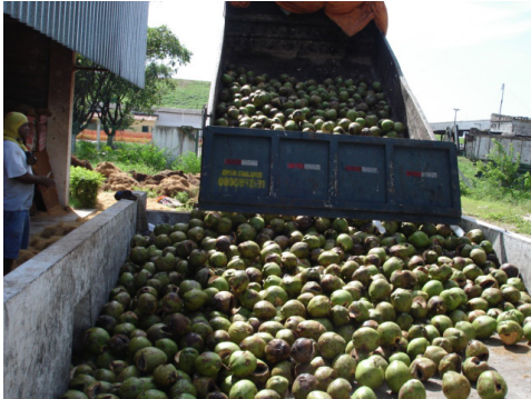
Figura 2. Descarga de cascas de coco na moega de alimentação da linha de processamento de casca de coco-verde.
