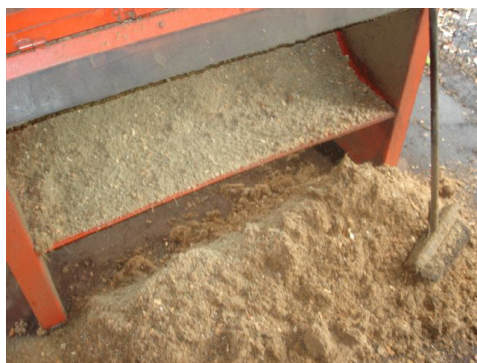
Figura 4. Descarga de pó da casca de coco-verde após classificação.
