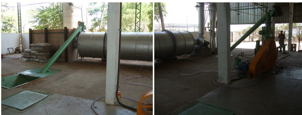
Figura 5. Secador rotativo para pó de casca de coco-verde.
