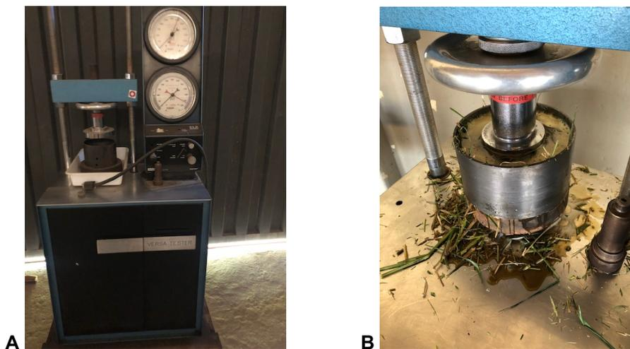
**Figura 1.** Prensa hidráulica com o cilindro que recebeu a biomassa para produção dos briquetes.
