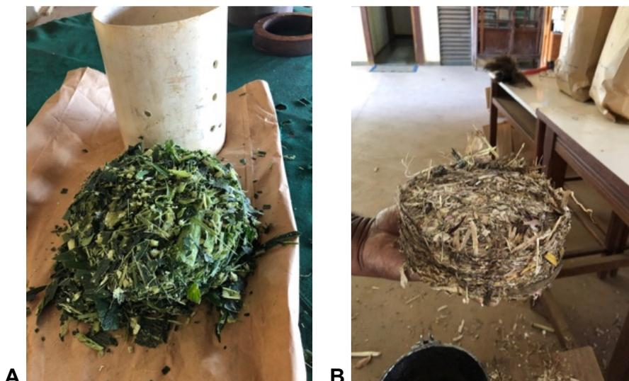
**Figura 2.** Sorgo biomassa BRS 716 com alta umidade (A) e material seco (B) após prensagem de 134 kN.
