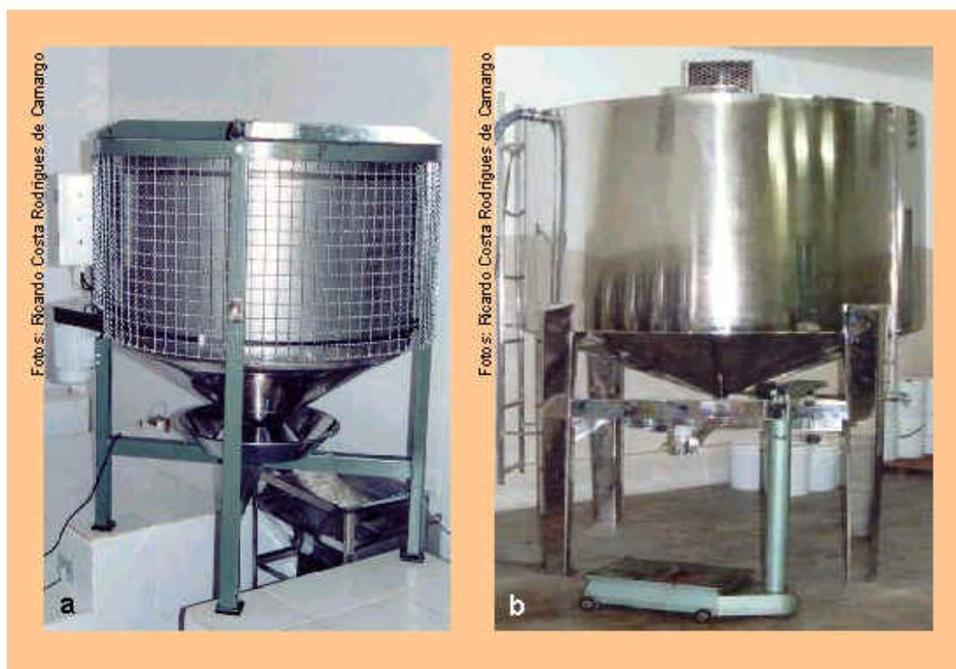
**Figura 3.** Equipamentos utilizados na extração e processamento do mel: centrífuga (a) e tanque homogeneizador (b).
