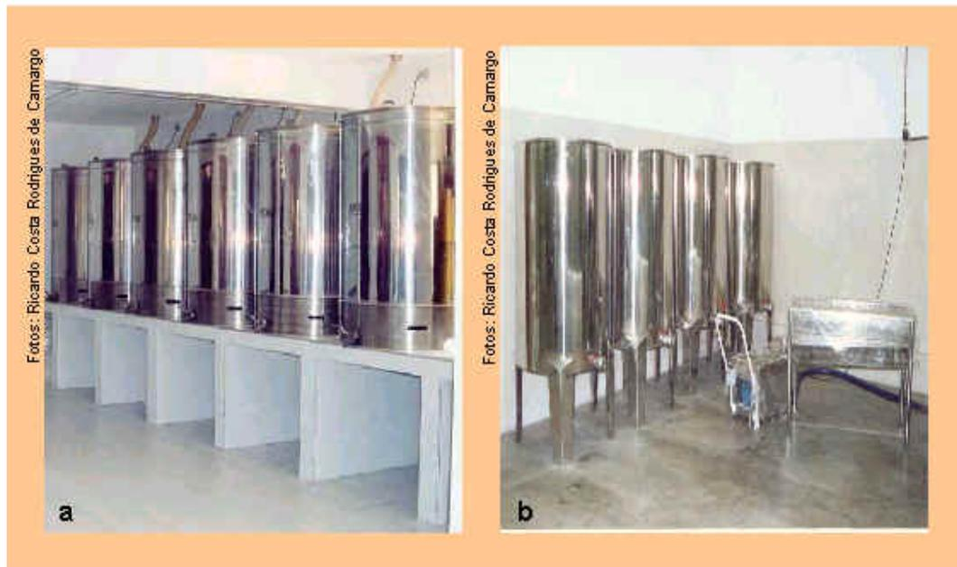
**Figura 2.** Modelos de decantador (a e b), mesa coletora de mel e bomba de mel (b).
