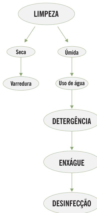
Figura 5. Esquema para limpeza e desinfecção das instalações após a saída do lote.
