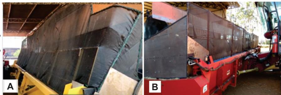
**Figura 9.** Rede de proteção fixada sobre o chassi das plataformas (A - 8230 e B - 7130) para evitar desperdício de grãos arremessados devido aos impactos recebidos pelos mecanismos móveis da plataforma (molinete, caracol e barra de corte).
