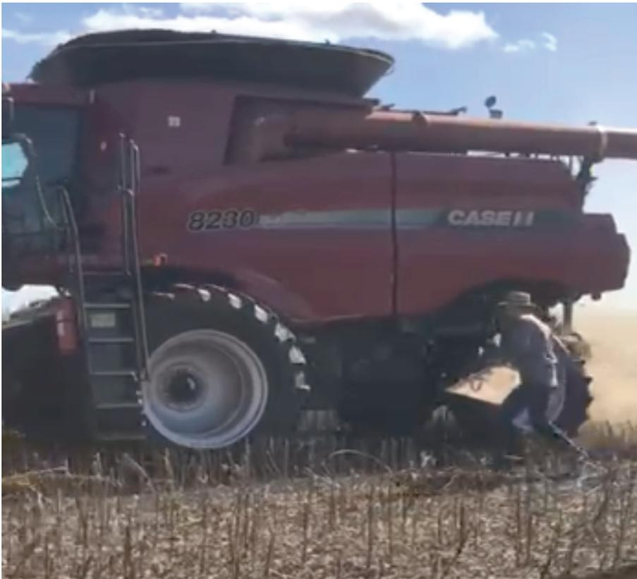
**Figura 14.** Máquina modelo Case IH 8230 em movimento na condição real de trabalho onde observa-se o lançamento do gabarito de 0,5 m<sup>2</sup> com tecido sob a colhedora com o propósito de recolher o material dispensado pelos mecanismos de separação e limpeza, permitindo assim a coleta de grãos perdidos internamente.
