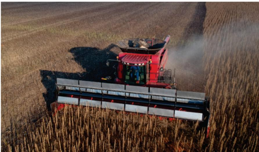
**Figura 1.** Vista frontal superior da colhedora Case IH 7130 com plataforma adaptada de aproximadamente 30 pés.
