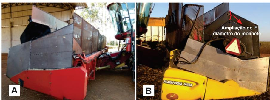
**Figura 10.** Proteções laterais do tipo chapa metálica fixados sobre os separadores da plataforma das colhedoras da marca Case IH, modelo 7130 (A) e modelo 8230 (B).
