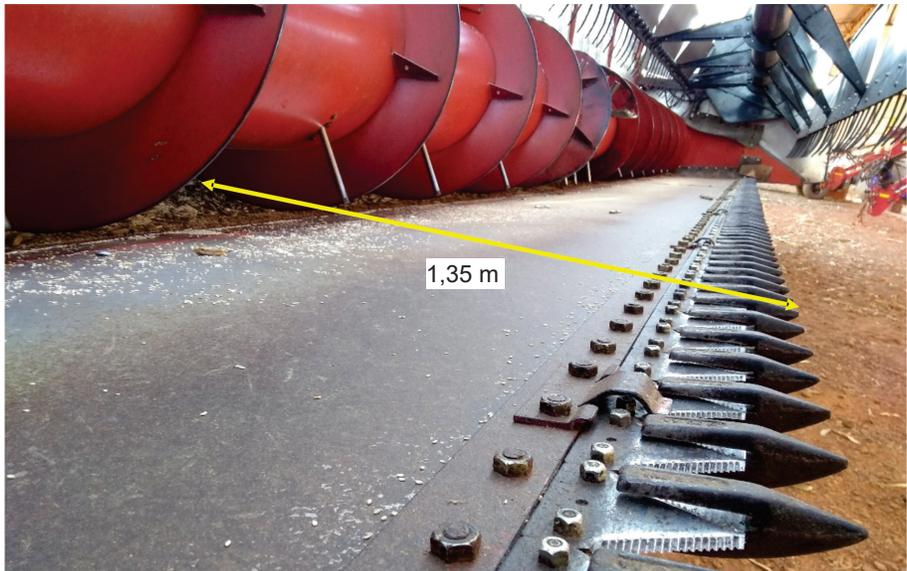
**Figura 6.** Detalhe da plataforma (Case IH 7130) com visualização da base alongada para 1,35 m ("tabuleiro"), da barra de corte, do condutor helicoidal (caracol) e da parte inferior do molinete.
