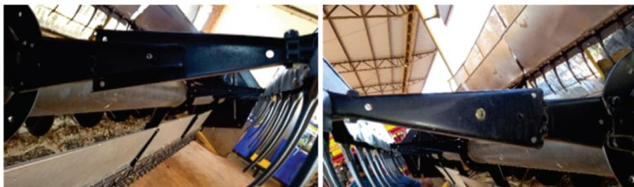
**Figura 7.** Detalhe do alongamento das chapas metálicas onde são fixadas as barras do molinete permitindo o aumento do diâmetro de giro para 1,4 m (adaptação em ambas as máquinas).
