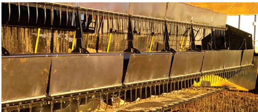
**Figura 8.** Detalhe das chapas metálicas fixadas sobre as barras do molinete sendo uma adaptação realizada em ambas as máquinas.
