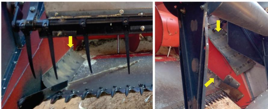
**Figura 11.** Vedações de borracha fixadas em locais com aberturas e propensos a vazamento de grãos (vedações similares para ambas as máquinas).
