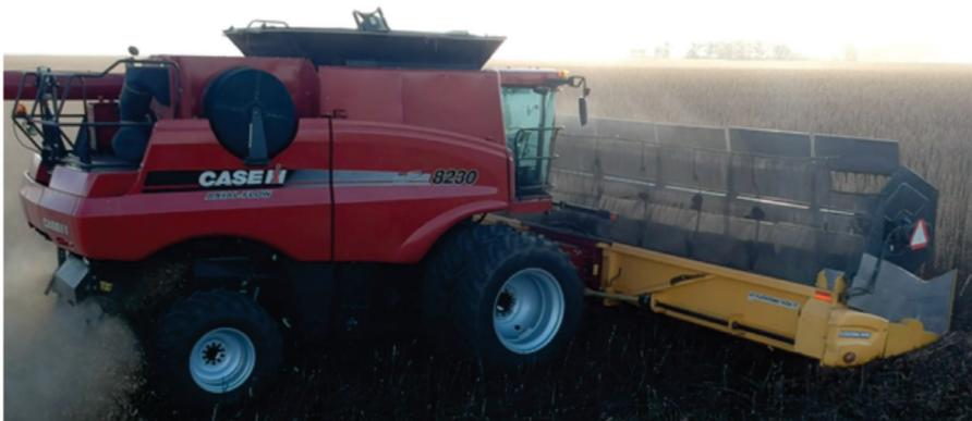
**Figura 2.** Vista lateral da colhedora Case IH 8230 com plataforma adaptada de aproximadamente 35 pés.
