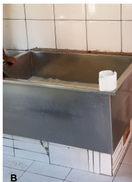
Figura 4. Recipientes de fabricação empregados na produção do queijo artesanal no município de Carvalhos-MG: tacho para fabricação de queijo em aço inox de formato cônico inserido em alvenaria (A), tanque para fabricação de queijo em aço inox (B) e caldeirão para fabricação de queijos em alumínio (C).
