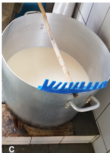
Figura 4. Recipientes de fabricação empregados na produção do queijo artesanal no município de Carvalhos-MG: tacho para fabricação de queijo em aço inox de formato cônico inserido em alvenaria (A), tanque para fabricação de queijo em aço inox (B) e caldeirão para fabricação de queijos em alumínio (C).
