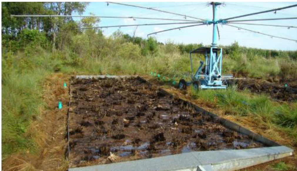
Figura 13. Instalação dos pluviômetros fabricados (em cor verde) ao redor da parcela de simulação
