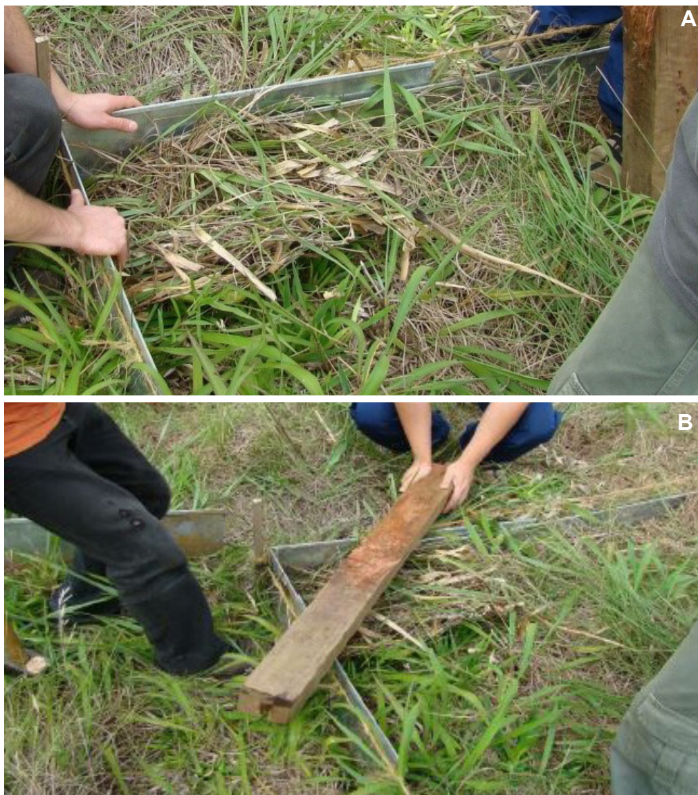
Figura 10. Posicionar a chapa de canto superior (A); cravar a chapa de canto superior (B).
