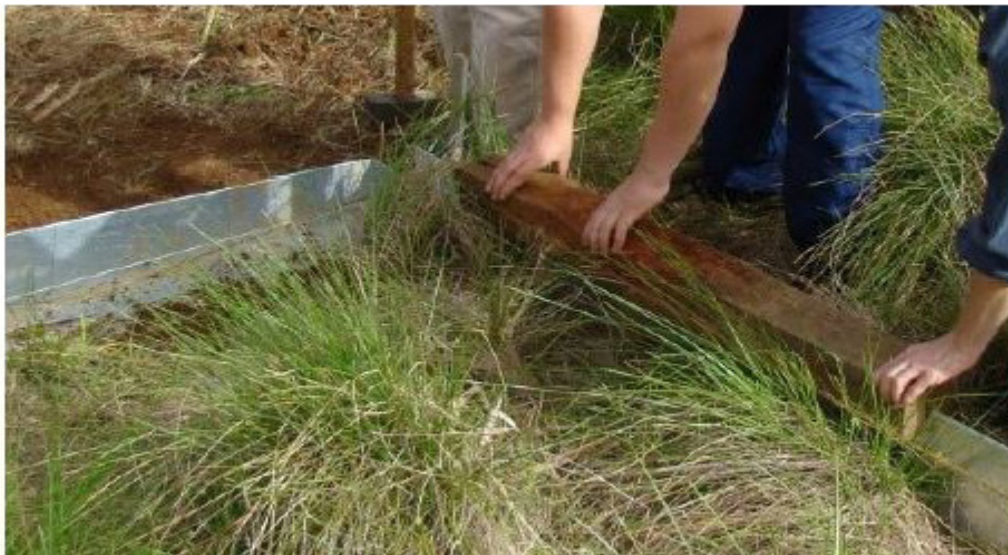
Figura 8. Instalar as paredes da parcela.
