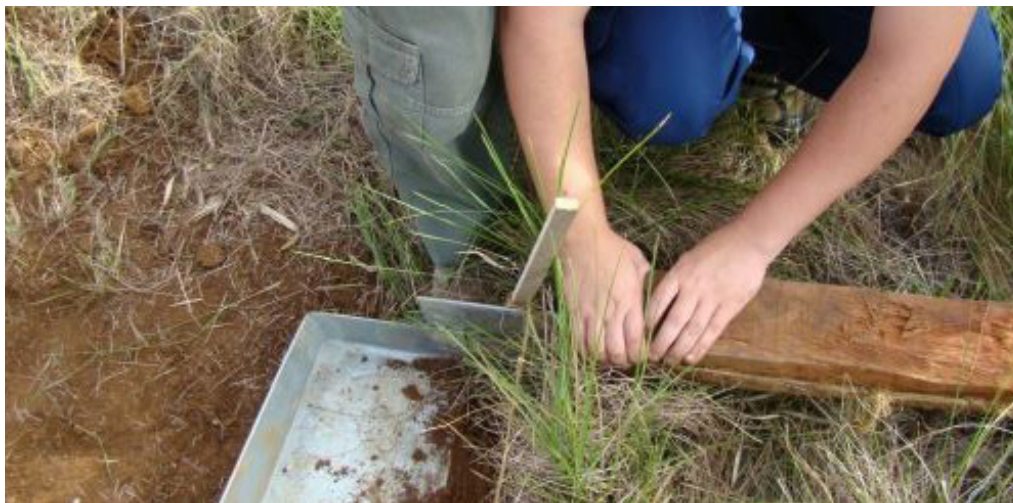
Figura 9. Manter o alinhamento entre as estacas e a sobreposição com a chapa anterior.
