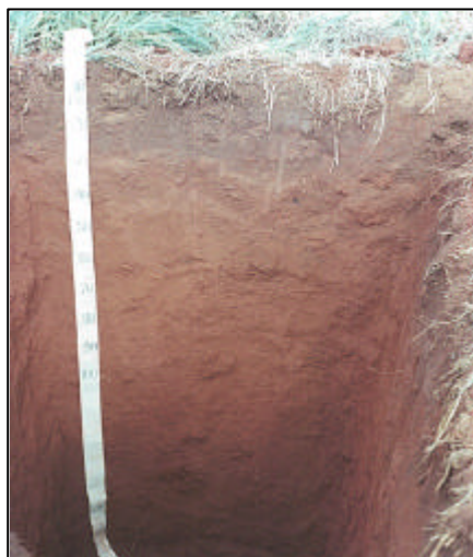
Fig. 13. Perfil de Latossolo Vermelho no Município de Castro, PR.
