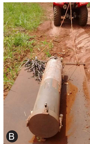
Figura 2. Equipamento para mensuração da condutividade elétrica aparente do solo (CEa). A) EM38-MK2® (Geonics, Mississauga, Ontário, Canadá); B) detalhe do suporte do equipamento EM38-MK2® para arraste pelo quadriciclo.
