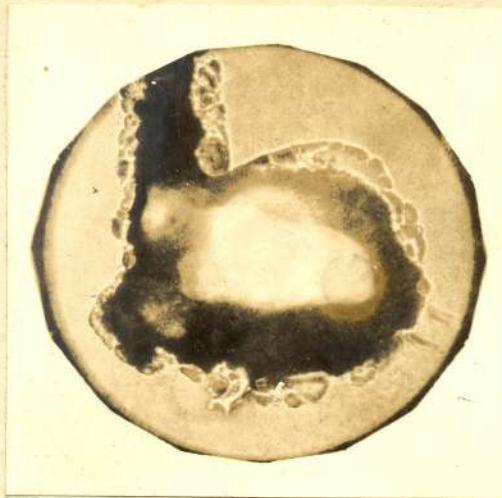
Fig. 47 - Cratera deixada no meio pelo anel do filamento, após a microcolecção.
