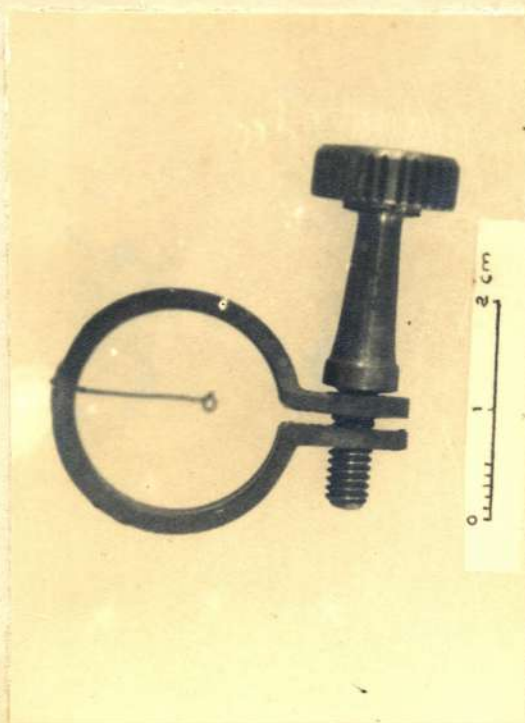
Fig. 43 - Microcoletor pronto para ser adaptado à objetiva do microscópio. Fig. 44 - As duas peças separáveis do microcoletor.
