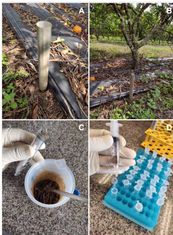
Figura 1. Montagem do experimento para extração de dsRNA em solo. Coleta da amostra de solo em área de plantação de citros (A e B). Transferência da amostra de solo para tubos de 15 mL após adição do dsRNA-GFP (C). Filtragem da amostra após suspensão em tampão PBS-T (D).
