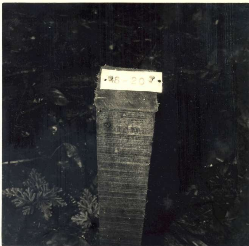
Fig.10 - Detalhe da parte superior de uma das estacas usadas na demarcação dos lotes, mostrando chapa de alumínio com numeração do hectare e do lote de 10 x 10 metros.
