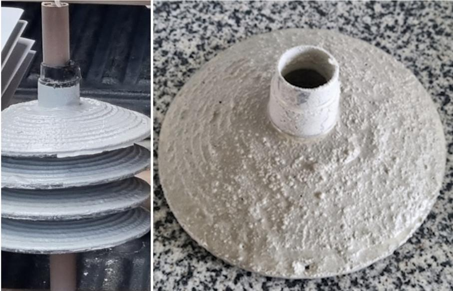
**Figura 9.** Coletores do tipo coupelles revestidos com mistura de cal e cimento.
