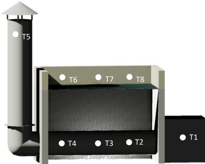
**Figura 11** – Esquema de posição dos termopares instalados no secador.
