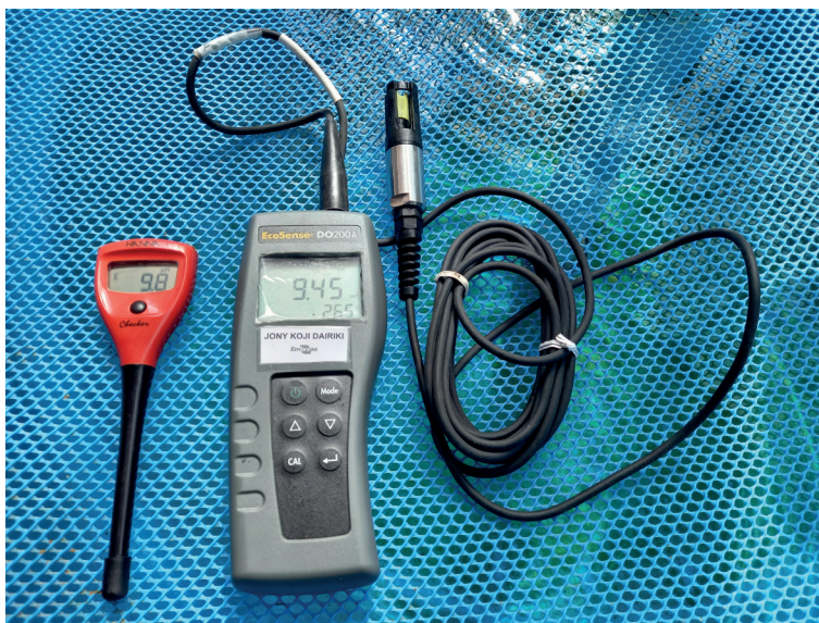
Figura 8. pHmetro e oxímetro digitais para monitoramento dos parâmetros de qualidade da água.
