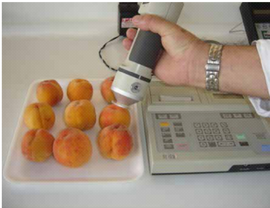
Figura 3. Medição da cor de pêssegos utilizando colorímetro.
