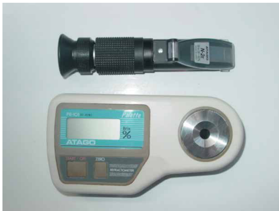
Figura 5. Modelos de refratômetros utilizados para a determinação do teor de sólidos solúveis.
