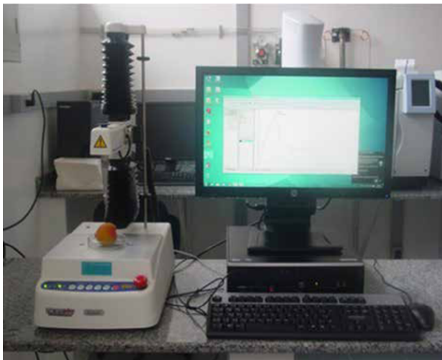
Figura 4. Texturômetro acoplado ao computador utilizado para a determinação da firmeza da polpa em pêssegos.
