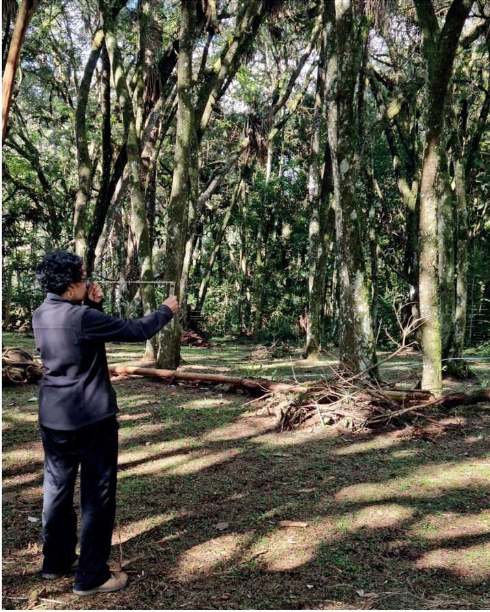
**Figura 4.** Posicionamento para uso do medidor de área basal, mirando o tronco das árvores à altura de 1,30 m (DAP).
