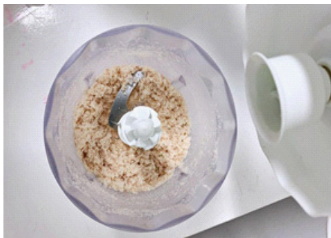
Figura 10. Amostra triturada com auxílio de processador de alimentos doméstico.
