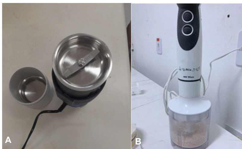
Figura 9. Moinhos utilizados para a moagem do material: Laboratorial (A) e processador de alimentos doméstico (B).
