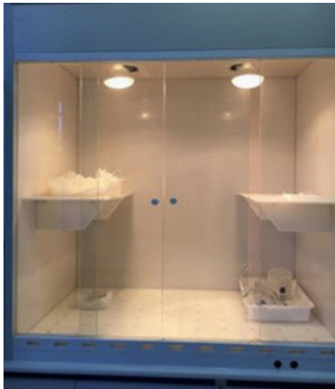
Figura 3. Capela construída em polipropileno para a secagem do material.
