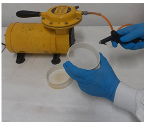
Figura 11. Compressor de ar sem óleo usado na limpeza das peneiras de nylon e processador de alimentos.
