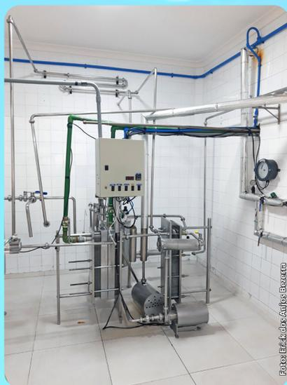
**Figura 5.** Pasteurizador rápido, utilizado para o tratamento térmico do leite de cabra na Agubel.
