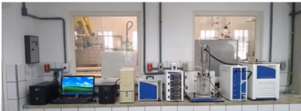
**Figura 49.** Estação de tratamento de esgoto em escala de bancada.
