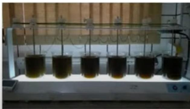
Figura 47. Delineamento experimental contendo 1 litro de lixiviado e diferentes massas de *Lithothamnium* para remoção de fósforo.
