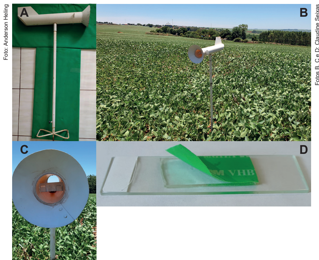
Figura 2. Visão geral do coletor de esporos (A); aspecto do coletor na lavoura (B); tubo visto de frente mostrando o suporte com a lâmina de vidro acoplada (C); lâmina de vidro com a fita dupla face (com a proteção superior parcialmente retirada) e etiqueta para identificação (D).
