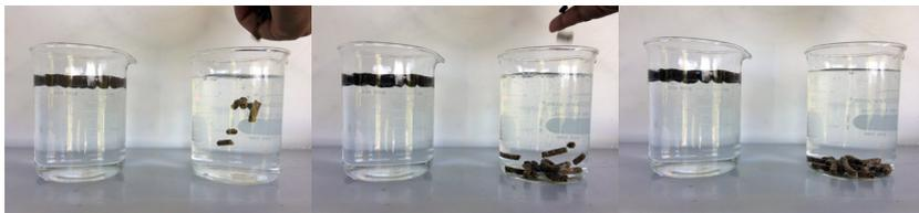
**Figura 3.** Demonstração da baixa flutuabilidade de uma ração artesanal peletizada comparada com uma ração comercial extrusada.
