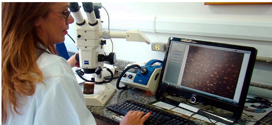
Figura 3. Obtenção de imagens de corpos de prova em estereoscópio com câmera acoplada.
