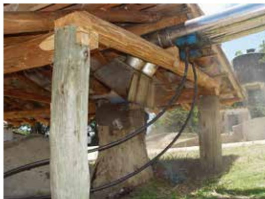
Produção do extrato pirolenhoso: forno concluído e detalhe da coleta do material resultante da condensação dos vapores da fumaça.
