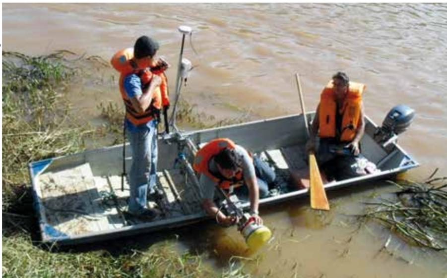
**Figura 3.** Medição de cheia em 14/1/2012, com perfilador acústico de correntes por efeito Doppler (Acoustic Doppler Current Profiler – ADCP), na Estação de Itapeurma, operada pela Superintendência Regional de São Paulo (Sureg-SP).
