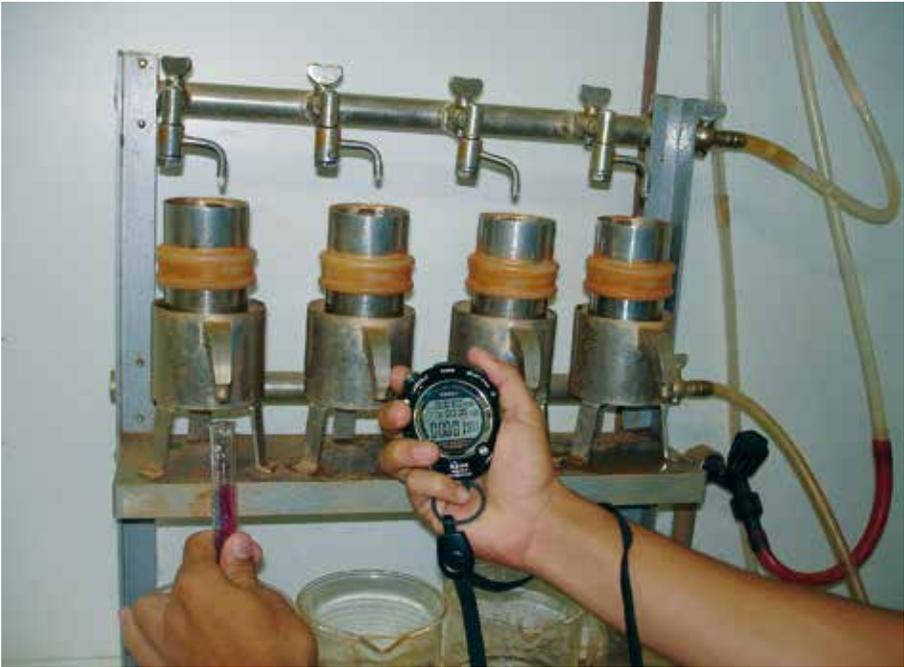
**Figura 6.** Teste, em laboratório, da condutividade hidráulica do solo saturado ( $K_s$ ).
