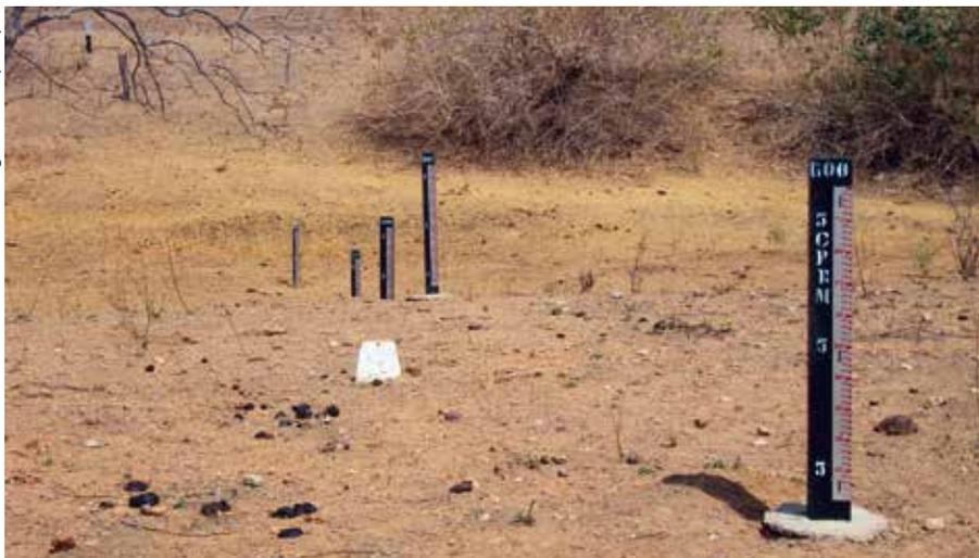
**Figura 2.** Estiagem na estação fluviométrica de Pau Ferro Montante, operada pela Superintendência Regional do Recife (Sureg-RE), em outubro de 2012.
