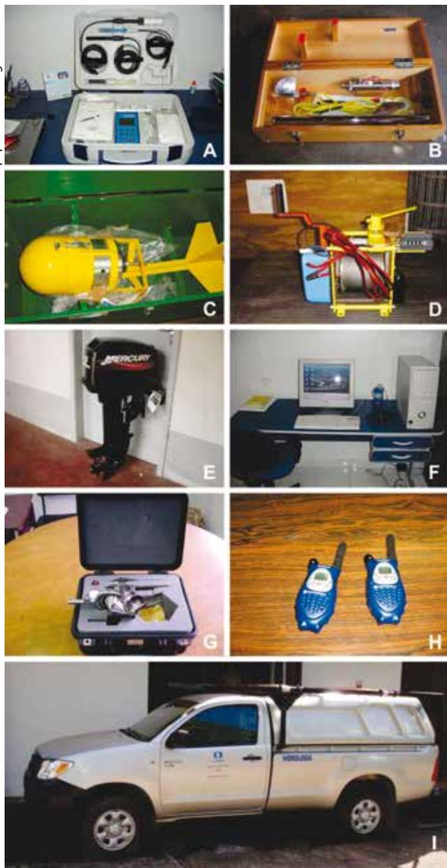
**Figura 1.** Equipamentos utilizados na Rede Hidrometeorológica Nacional (RHN): conjunto de equipamento de QA (A); molinete eixo horizontal (B); amostrador de sedimento tipo sacca (C); guincho hidrométrico motorizado (D); motor de popa (E); utensílios de informática (F); molinete eixo vertical (G); rádio tipo walkie-talkie (H); veículo (I).
