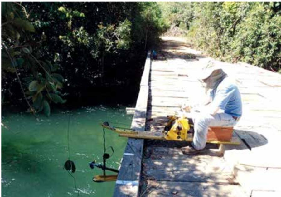
**Figura 5.** Medição de descarga líquida em ponte, usando o método área x velocidade.
