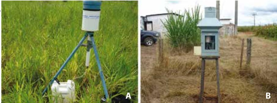
**Figura 4.** Estrutura adaptada ao pluviômetro para coleta e armazenamento da água da chuva (A); e pluviógrafo mecânico utilizado como referência na avaliação do pluviômetro da estação climatológica (B).
