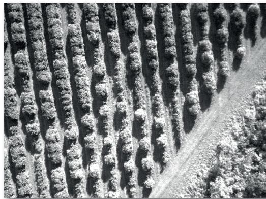
**Figura 18.** Efeito BRDF em imagem tomada com câmera multiespectral Micasense RedEdge (banda Borda do vermelho Red Edge).
