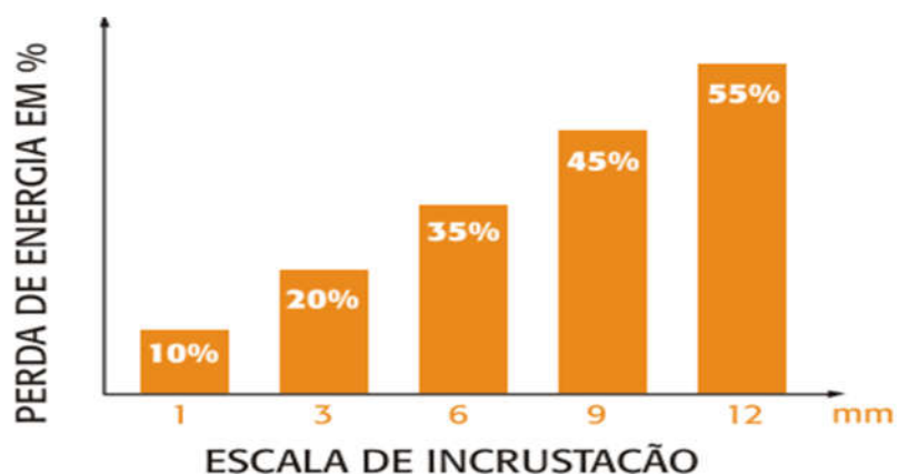
Figura 6 - Valores médios de perda de calor causada por incrustação.
