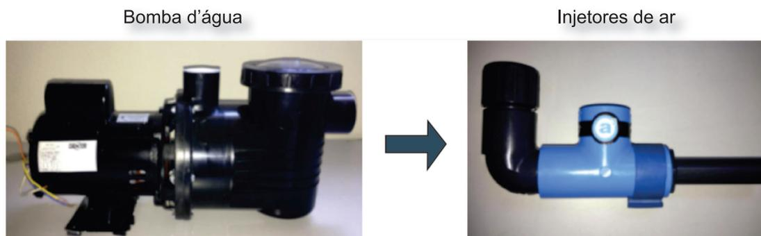
**Figura 33.** Aeração com injeção de ar de forma difusa: bomba-d'água acoplada a injetores de ar.
