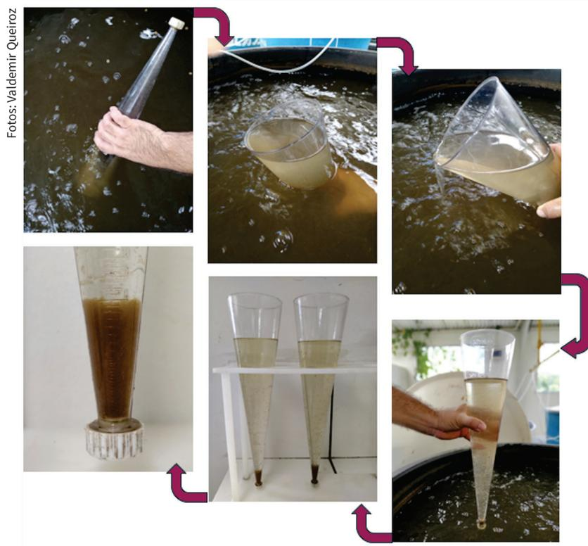
**Figura 36.** Coleta e leitura de sólidos sedimentáveis (mL/L).
