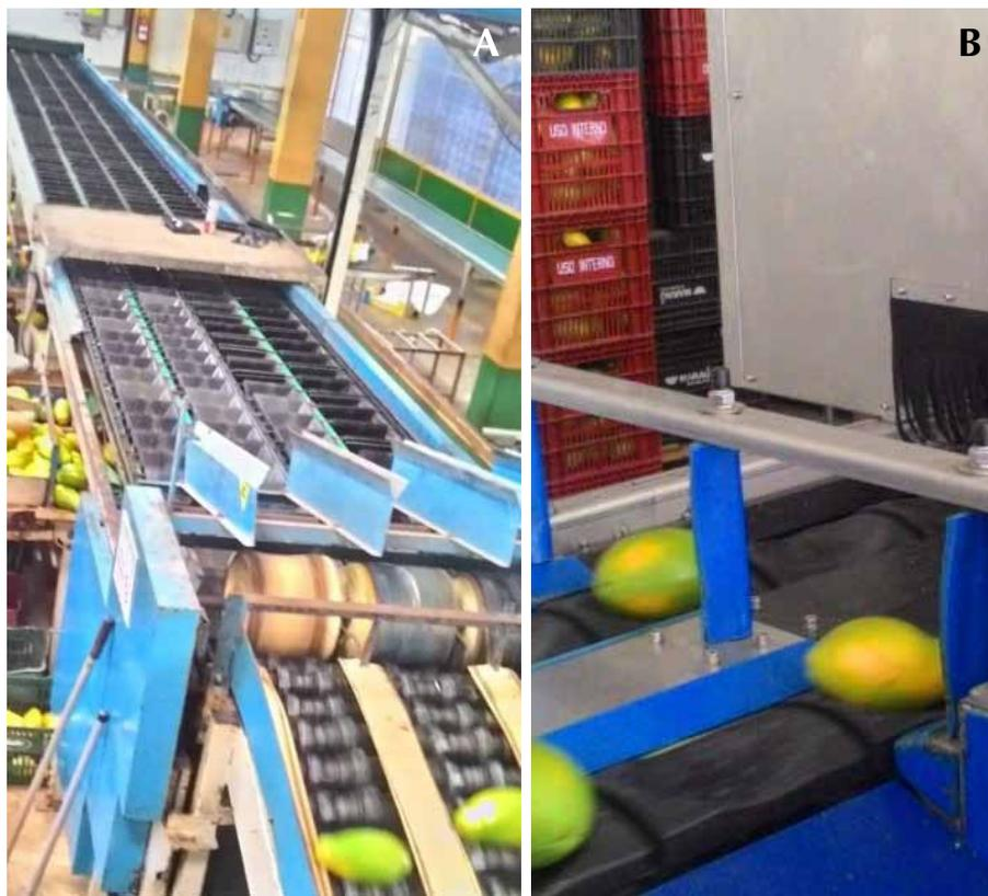
**Figura 8.** Classificador automático com bandeja individuais (A) e detalhe do equipamento para classificação por coloração da casca (B).
